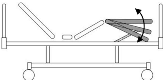
Икроножная секция ложа может устанавливаться на различных уровнях.
